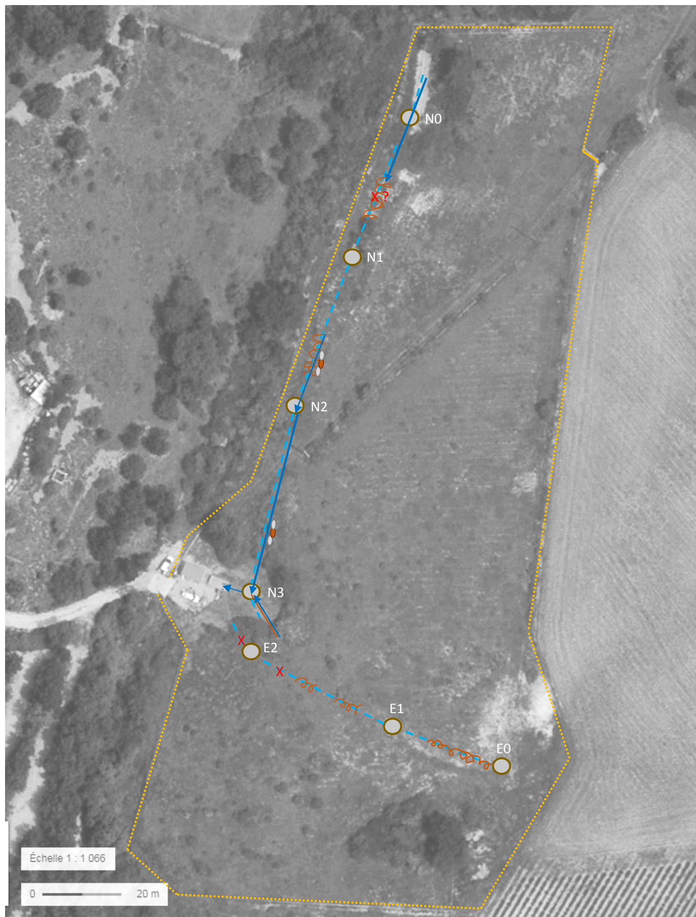
PG 4 Font de Save : localisation des drains et regards, état du système de captage le 09/10/2017
